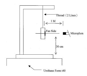
1 METER FROM MICROPHONE TO FAN INTAKE
