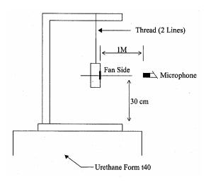
1 METER FROM MICROPHONE TO FAN INTAKE
