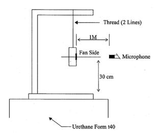
1 METER FROM MICROPHONE TO FAN INTAKE
